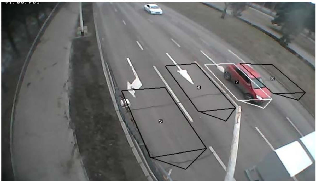
Figura 2. Espira Virtual, Ocupación e Intensidad de una Cámara de Tráfico
